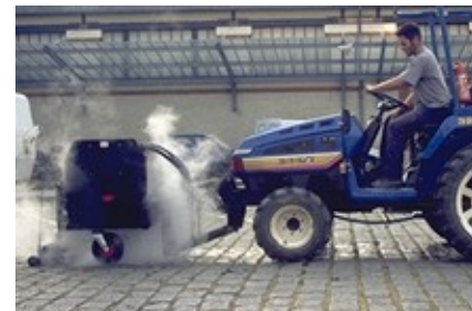
Le désherbage à la vapeur (photo FEREDDEC)
